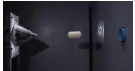
조류충돌 시험 초고속 카메라 촬영 모습
